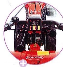
Dispositivo di impedimento della retromarcia con la presa di forza inserita nelle operazioni di fresatura.
