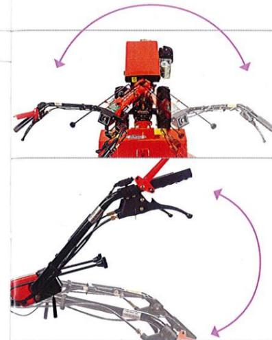
La regolazione in altezza delle stegole di guida in ben 9 posizioni consente l'uso del motocoltivatore ad ogni componente della famiglia per qualsiasi operazione. Inoltre, le stegole regolabili lateralmente in 5 posizioni permettono all'operatore di non calpestare il terreno già lavorato. Ruotando di 180° le stegole di guida, con un semplice e rapido comando si possono utilizzare attrezzature frontali quali: tosaprato, falciatrice, fresa da neve, ruspa, etc...
